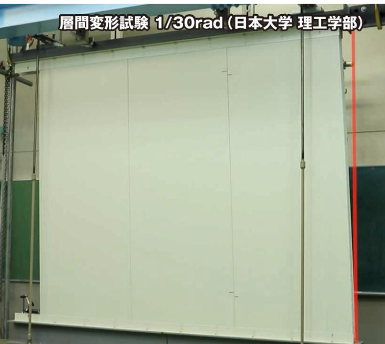
層間変形試験  $1/30\text{rad}$  (日本大学 理工学部)
