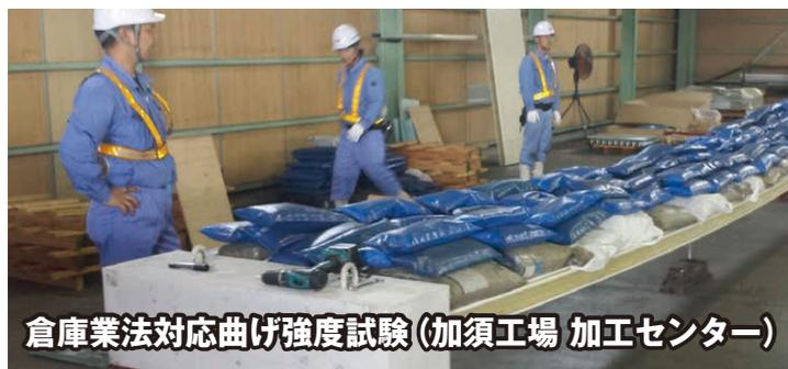
倉庫業法対応曲げ強度試験 (加須工場 加工センター)
